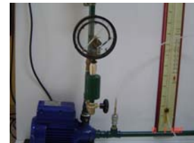
Figura 3 Nesta situação a pressão de entrada não é diretamente a lida no manômetro
