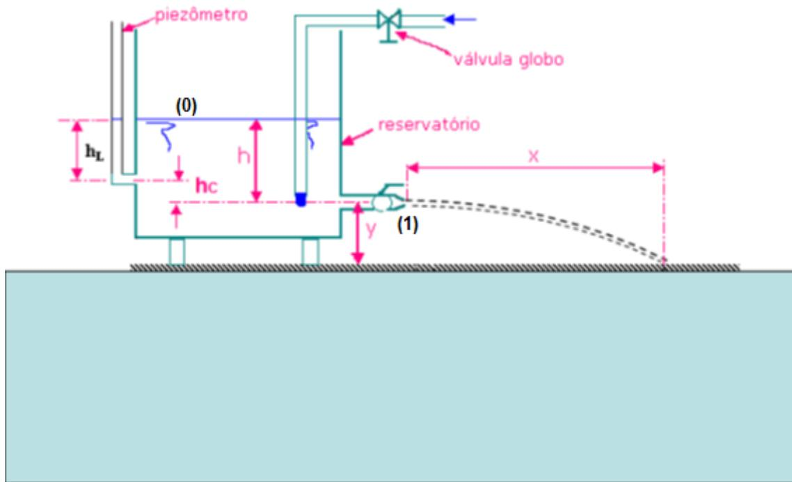
Aplicando-se a equação de Bernoulli de (0) a (1) possibilita a determinação da velocidade teórica:
