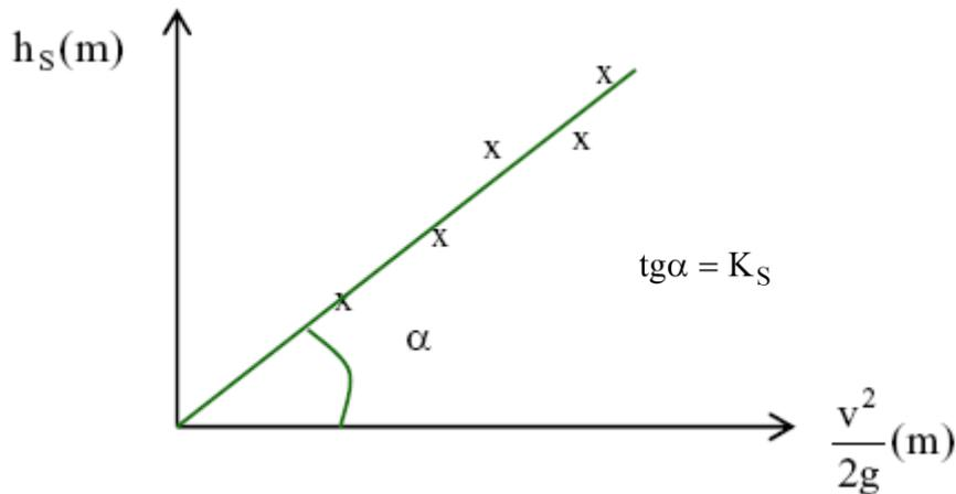
Nesta experiência procurou também a determinação do comprimento equivalente da redução, onde o diâmetro hidráulico considerado é o diâmetro interno de 1" com espessura 40 ( $D_{int} = 26,6\text{mm}$ ) e o coeficiente de perda de carga distribuída é a média dos obtidos experimentalmente na experiência de perda de carga distribuída.
