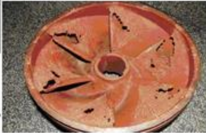
Figura 1.3 – Rotor de bomba centrífuga danificado pela cavitação.
