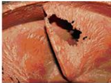
Figura 1.3 – Rotor de bomba centrífuga danificado pela cavitação.
