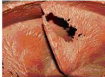
Figura 1.3 – Rotor de bomba centrífuga danificado pela cavitação.
