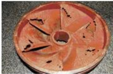
Figura 1.3 – Rotor de bomba centrífuga danificado pela cavitação.
