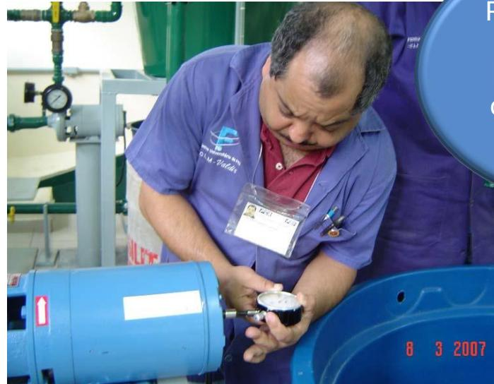
Reforçando, para cada vazão lemos a rotação com o auxílio de um tacômetro.
