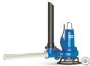
Baseado no princípio de ejeção, o aerador ABS Venturi Jet é uma solução ideal para profundidades entre 1,5 m e 5 m. Fornece areação e mistura com uma boa relação custo-benefício em aplicações de efluentes municipais e industriais, tanques de retenção de água da chuva e tanques de balanceamento.
