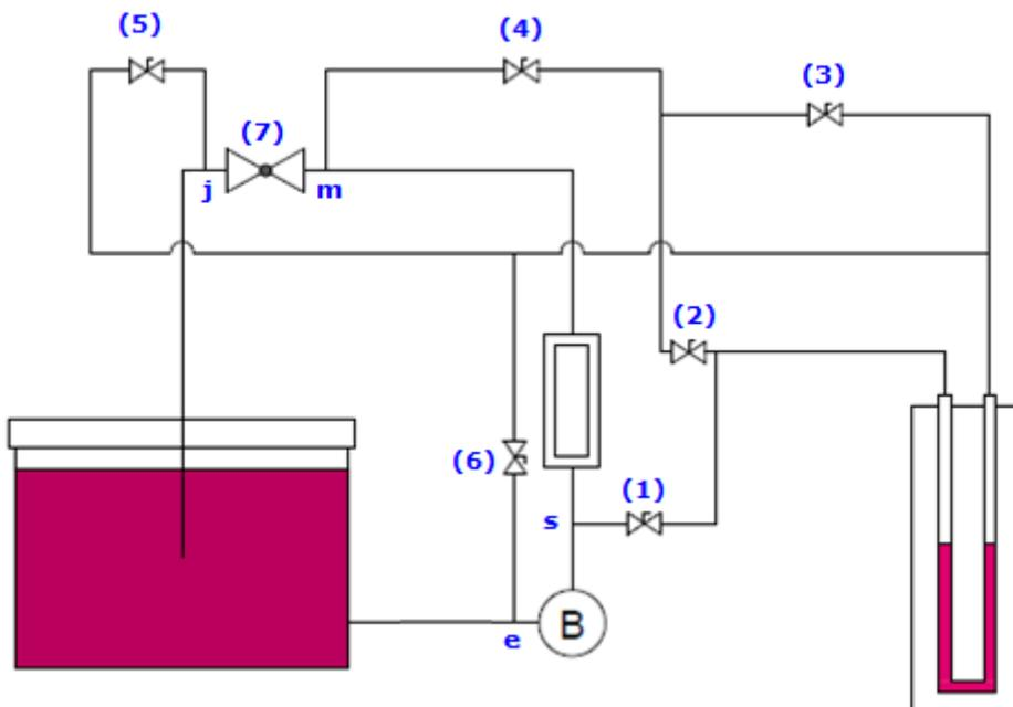
(1), (2), (3), (4), (5) e (6) = mini válvula esfera; (7) = válvula agulha; (e) e (s) respectivamente seção de entrada e saída da bomba marca EMICOL; (m) e (j) respectivamente seção imediatamente a montante (antes) e a jusante (depois) da válvula agulha.
