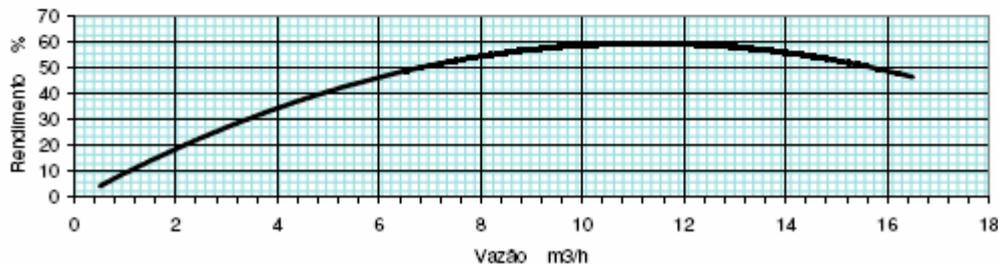
Com a curva fornecida pelo fabricante podemos obter a associação em série das bombas B7 e B8, que são iguais, mas isso para uma rotação de 3500 rpm e é por esse motivo que devemos corrigir os valores experimentais para essa rotação.
