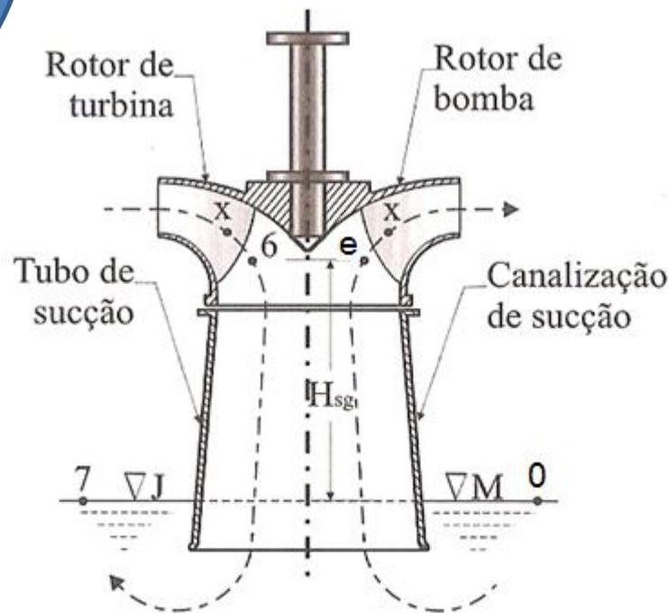
Corte longitudinal esquemático da canalização de sucção e do rotor de uma bomba centrífuga, à direita do eixo vertical da figura, e de uma turbina hidráulica, à esquerda do eixo.
