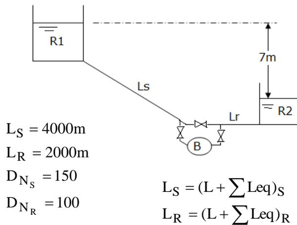
Considere a tubulação nova com  $k = 2,59 * 10^{-4}$  m, por onde escoava água a 30°C e despreze a variação de perda de carga com a instalação operando com e sem bomba.
