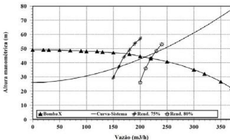
**6ª Questão (valor 2,0)** – Para o sistema apresentado a seguir, onde a água a 30°C escoava de R1 para R2, determine o seu ponto de funcionamento e o acréscimo de vazão proporcionado pela bomba, que tem  $H_B = f(Q)$  dada pela tabela a seguir.
