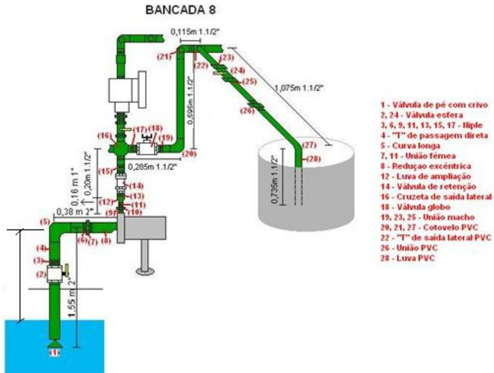
**Importante:** considere que a leitura barométrica seja igual a 680 mmHg, que a temperatura média da água seja 35°C e que a cota da seção de entrada da bomba, considerando o PHR de referência no nível d'água é 1,15 m.
