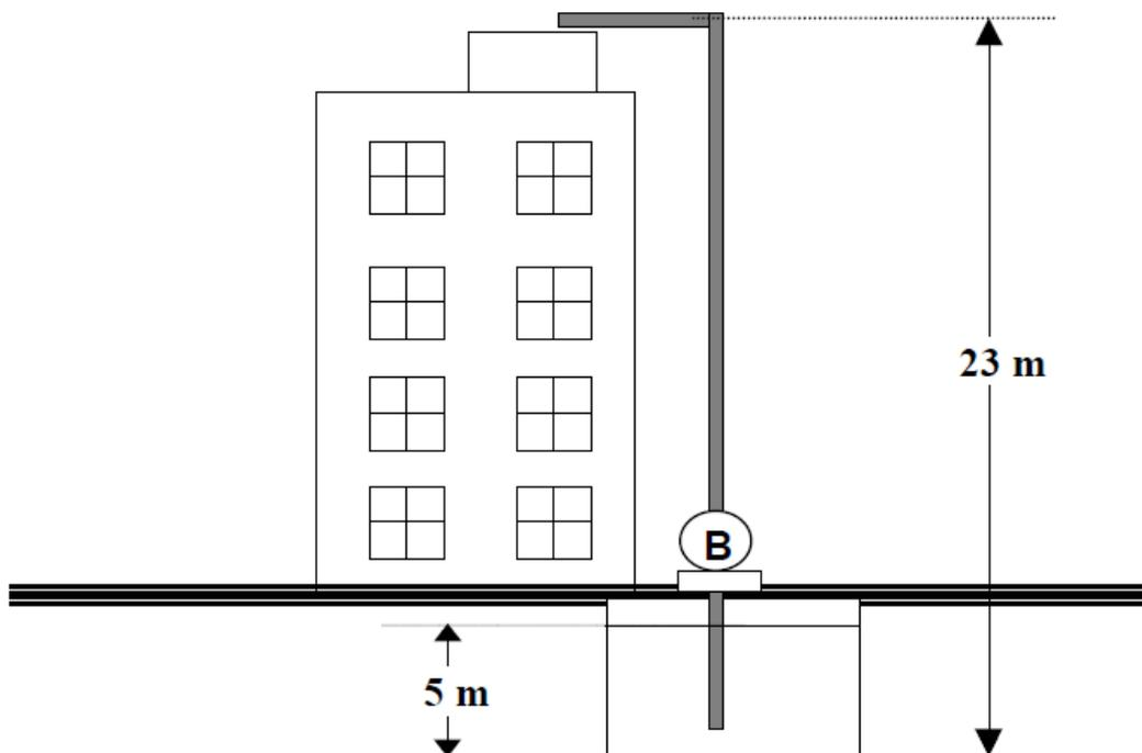
**2ª Questão (valor 2,0)** - Calcular a potência da bomba para elevação da água até o reservatório superior. Considere a velocidade do fluido no ponto 2 como sendo 2,5 m/s. Para definirmos as perdas de carga, considere que as curvas e válvulas acrescentam um comprimento equivalente de trecho reto da seguinte forma:
