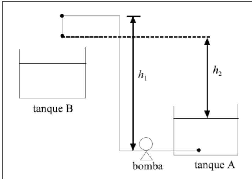
1. Para uma dada vazão de líquido e perda de carga na tubulação e nos acidentes, a potência da bomba depende de  $h_1$  e não depende de  $h_2$ .
