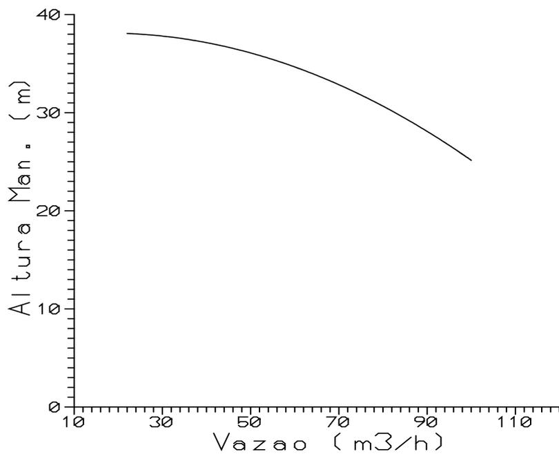
**Dados:**  $h_{S_{TC1}} = 0,019 \times Q^2$ ;  $h_{S_{TC2}} = 0,018 \times Q^2$  e  $h_{S_{TC3}} = 0,0105 \times Q^2$  com  $h_{S_{TCi}}$  em "m" e Q em "m³/h".
