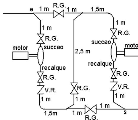
Sabendo que a instalação trabalha com um único diâmetro e que os tubos são de aço 40 com diâmetro nominal de 2", pede-se, explicando as operações com as válvulas gaveta, determinar a vazão originada na alimentação do reservatório inferior.
