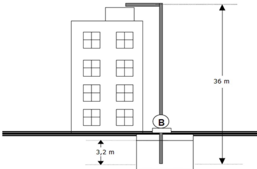
**2ª Questão (valor 2,0)** - Calcular a potência da bomba para elevação da água até o reservatório superior. Considere a velocidade do fluido no ponto 2 como sendo 2,9 m/s. Para definirmos as perdas de carga, considere que as curvas e válvulas acrescentam um comprimento equivalente de trecho reto da seguinte forma:
