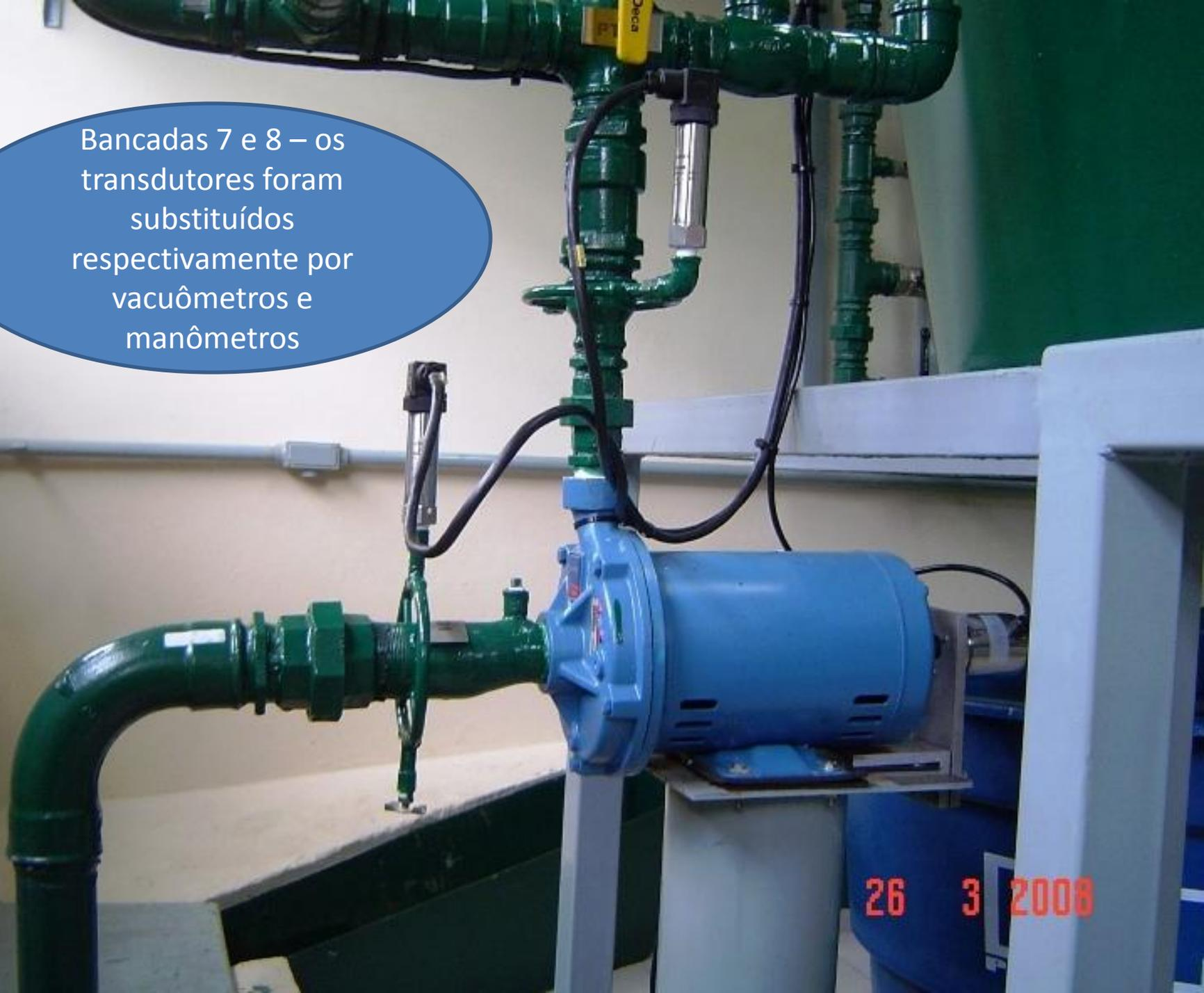
A determinação da carga manométrica em função da vazão do escoamento é obtida através da equação da energia aplicada entre a entrada e saída da bomba, onde as perdas não são consideradas nesta equação, já que foram consideradas no rendimento da bomba.
