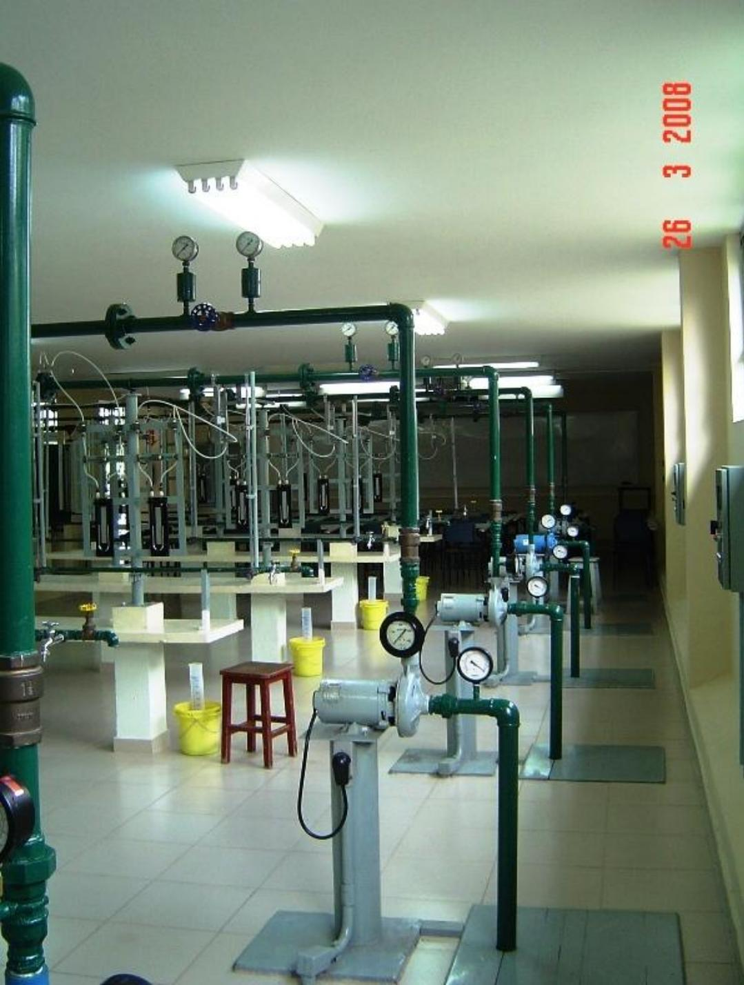
Obtenção da curva característica da bomba (CCB) considerando a sua rotação real e comparação da mesma com a fornecida pelo fabricante.
