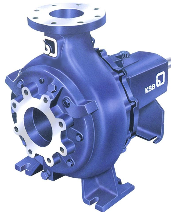
Bomba centrífuga horizontal, bipartida radialmente montada sobre pés de apoio, projeto "back pull out", com rotor em balanço.
