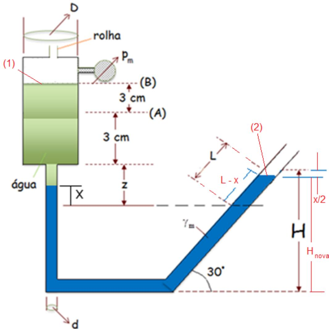
Para facilitar a solução deste item, vamos evocar o conceito de equação manométrica. Equação manométrica é uma regra prática para se obter a diferença de pressão entre dois pontos fluidos e para aplicá-la devemos:
