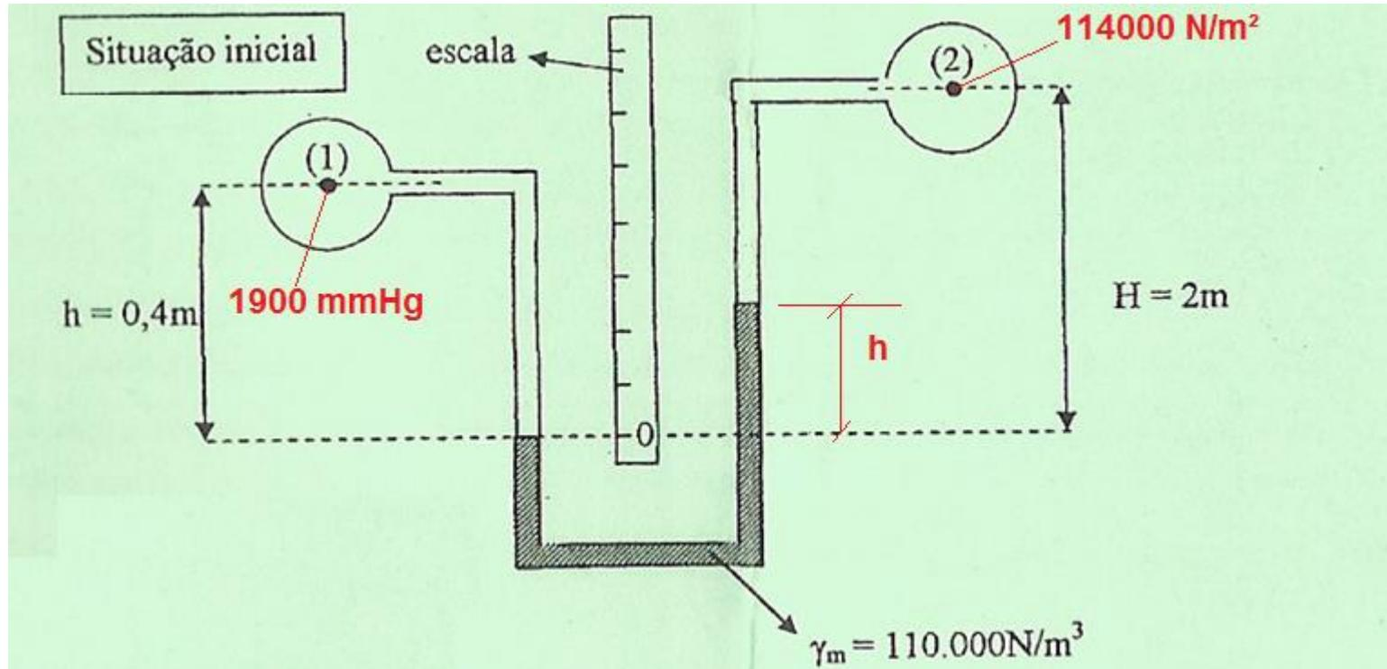
Aplica-se a equação manométrica de (1) a (2), adotando-se como origem (1):
