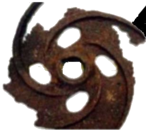
rotor danificado pela cavitação em uma bomba
