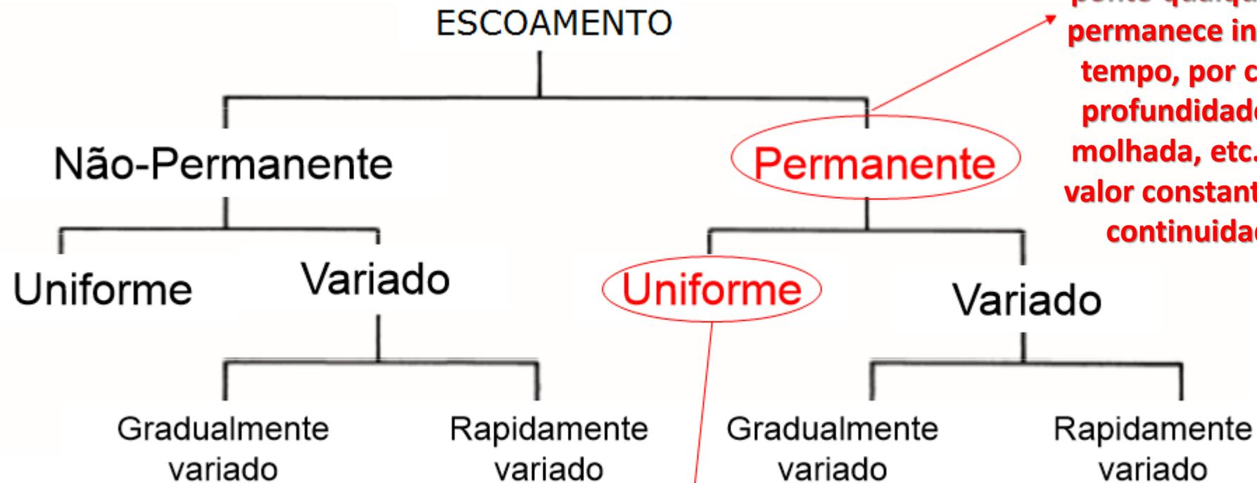
A velocidade local em um ponto qualquer da corrente permanece invariável com o tempo, por conseguinte, a profundidade, vazão, área molhada, etc., guardam um valor constante e existe uma continuidade de vazão
