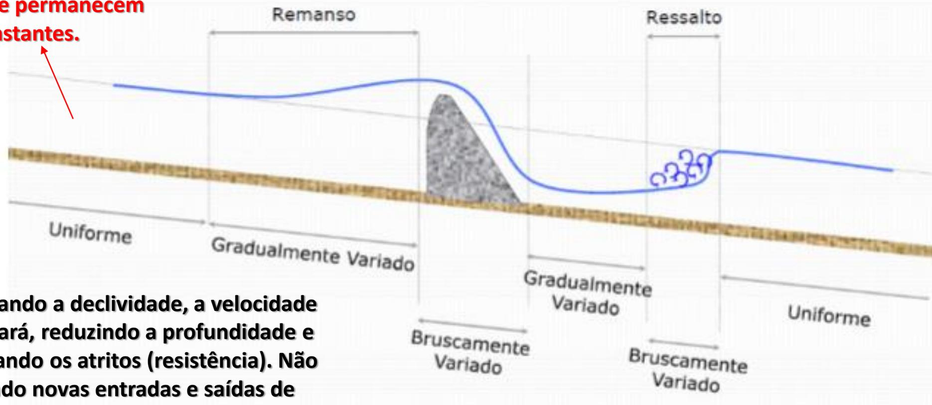
Aumentando a declividade, a velocidade aumentará, reduzindo a profundidade e aumentando os atritos (resistência). Não havendo novas entradas e saídas de líquido, a vazão será sempre a mesma e o escoamento permanente.
