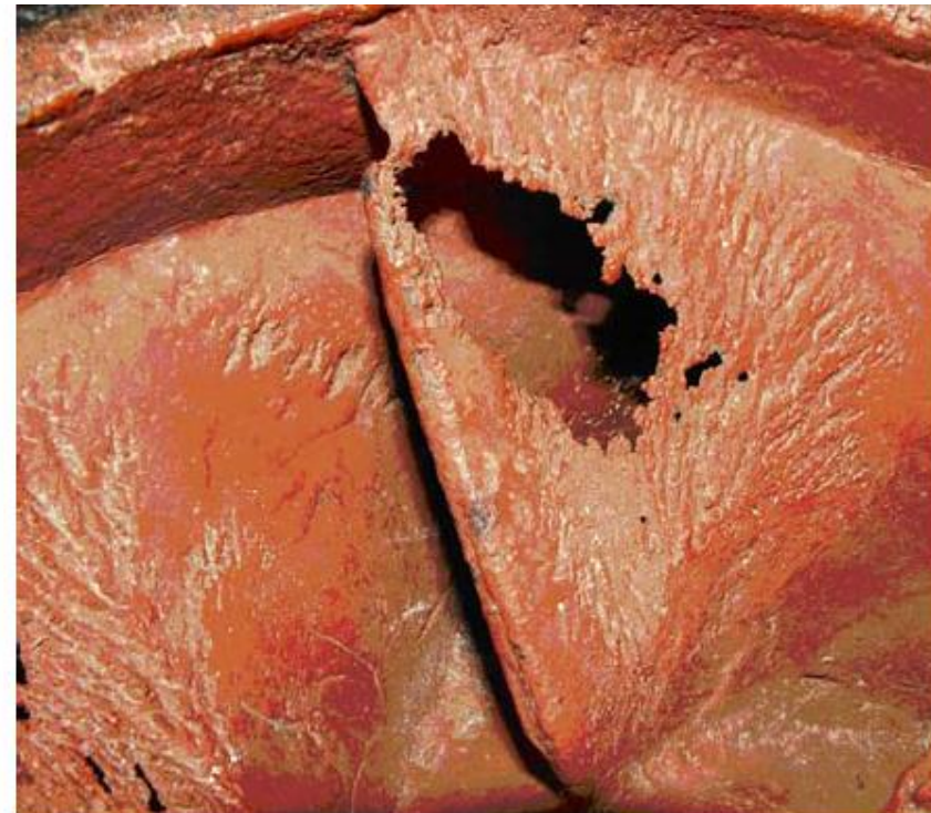
Figura 1.3 – Rotor de bomba centrífuga danificado pela cavitação.
